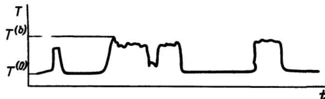
Рис. 1.19. Осциллограмма пульсаций температуры при горении однородной смеси по данным Кокушкина [1960]. Опыты проведены с бензино-воздушной смесью; коэффициент избытка воздуха \alpha = 1,6 - 1,8 ; начальная температура 573 К; давление нормальное. Смесь горела за коническим стабилизатором диаметром 6 см, расположенным на срезе трубы диаметром 40 см. Скорость истечения составляла 90–110 м/с. Измерения проводились на расстоянии 40 см от среза трубы. Единицы измерения по осям координат произвольны
