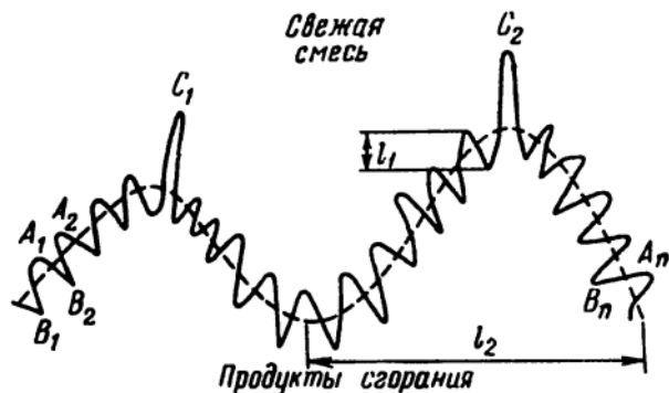
Рис. 6.9. Качественная структура турбулентного пламени
