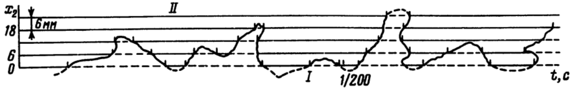
Рис. 1.20 "Замороженное" положение фронта пламени по данным Кокушкина [1960] Условия опытов те же, что и на рис. 1.19
